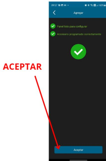
5) El sensor se registrará automáticamente en modo SOS, esto significa que podrá disparar la alarma durante las 24hs, sin importar si la alarma está activa o no. Verifique la configuración del sensor para asegurarse de que esté en modo SOS y en caso de no estarlo, seleccione esta opción manualmente.
