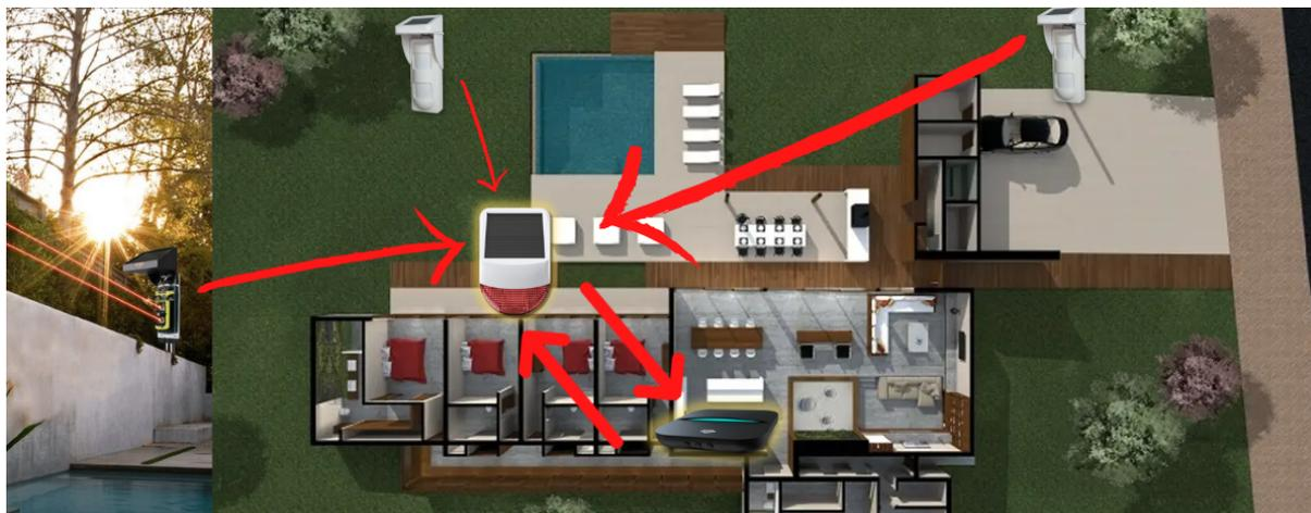
Como se ve, al estar a gran distancia y con muchas paredes de por medio, es posible que los sensores y barreras de exterior no lleguen con su señal al panel de alarma. Pero si pueden llegar correctamente a la sirena, quien retransmitirá la señal de los sensores al panel de alarma, logrando coberturas de hasta 200m desde el panel hasta los sensores.
